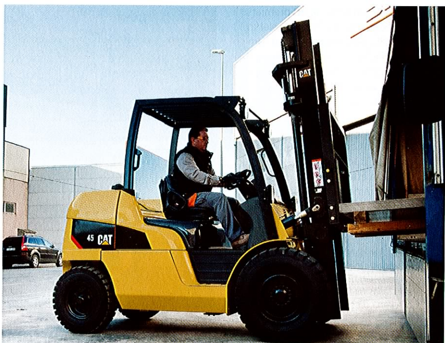
Cats nya dieseltruckar för 4 till 5,5 ton, DP40-55N, är utrustad med flera funktioner som underlättar service. Bland annat visas felkoder på instrumentpanelen och en timmätare håller koll på serviceintervallen.
